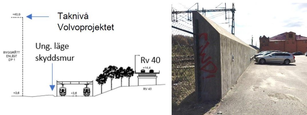
Till vänster Sektion över föreslaget läge på skyddsmur mot avåkande tåg samt till höger foto på liknande skyddsmur utmed järnväg söderut inom f.d. Lyckholms fabriker.
